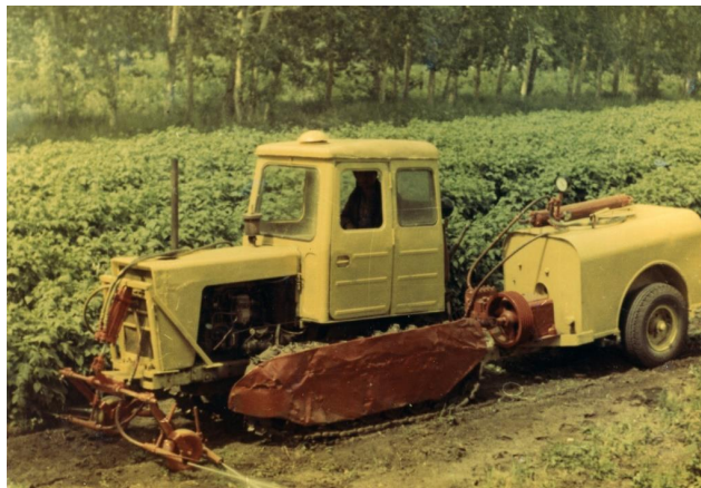
Рисунок 2. Машина по удалению поросли струей воды высокого давления (наше изобретение)
